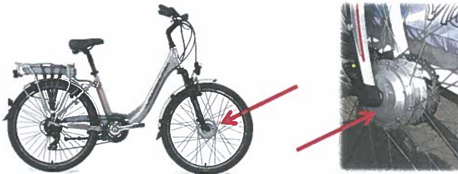
Bezkartáčový elektromotor umístěný ve středu předního kola
