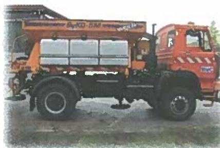
Výměnná nástavba - posypové zařízení – určena pro zimní údržbu silnic.
