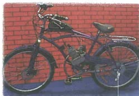
Kolo se spalovacím motorem
