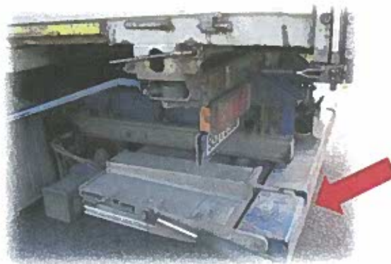
Pracovní stroj nesený – zvedací plošina
